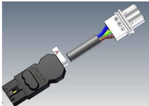
Bauseitige Stromleitungen (H05VV-F 3G 1mm<sup>2</sup> bis max. 2,5mm<sup>2</sup>) auf Wieland Einbaubuchsen auflegen. Abmantellänge 15mm, 6mm abisoliert. Beim Anschließen auf die Polarisierung achten.
