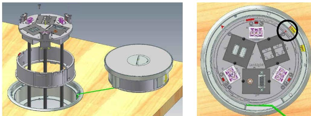
Der Deckel kann nun aufgesetzt werden. Darauf achten, dass die Staubschutz-Borsten des Deckels nicht eingeklemmt werden.
